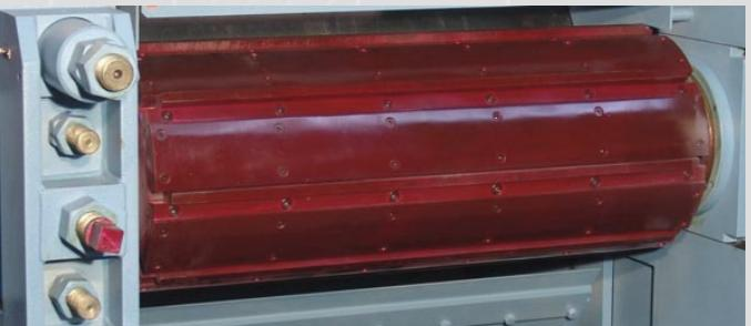
Cilindro liscio con camicia in lega di ghisa speciale altolegata. Per la protezione della macchina da eventuali sovraccarichi, i 2 supporti del cilindro lento poggianno contro adeguati dispositivi con molle pre-caricate che, all'occasione, permettono l'immediato allontanamento del rullo per il passaggio di corpi estranei di limitate dimensioni.
