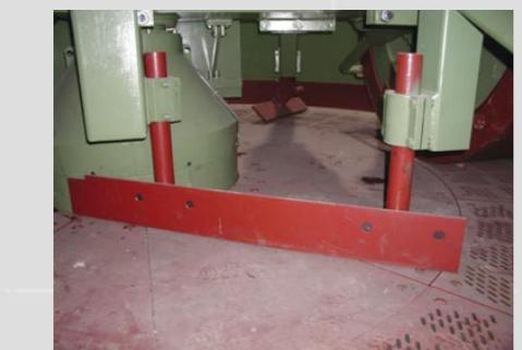
Connexion du racloir de réalimentation
